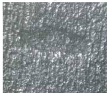
**Рис. 5.9.** Структура и характер поражения стали Ст3 в 3%-ном растворе NaCl, насыщенном сероводородом и подкисленным СНЗСООН до pH = 5 [39]:
